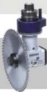
HSK F63 Testa angolare semplice per l'alloggiamento di una lama sega con 1 uscita (tappo ATLOCK), max. Ø 240 mm N. ord. 300-24-009 max. Ø 300 mm N. ord. 300-24-008
