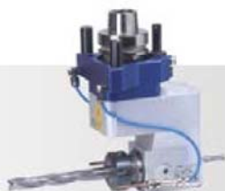
HSK F63 Gruppo piegato a gomito con 1 uscita ER 32 per utensile di fresatura e foratura o utensile di fresatura con due ugelli di soffiaggio aria compressa e 1 uscita ER 16 per utensile di fresatura e foratura N. ord. 300-24-017 N. ord. 300-24-038 (H08 21-31P)
